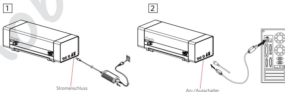
Schalten Sie die Maschine an, indem Sie den An-/Ausschalter betätigen. Wenn Ihr PC das „Neue Hardware gefunden“-Dialogfenster angezeigt hat, dann sollten Sie den empfohlenen Anweisungen folgen, um den Silhouette Curio™-Treiber zu installieren.
