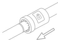
Schieben Sie die Walze in die gewünschte Position, während Sie die Verriegelungstaste gedrückt halten. Lassen Sie die Taste am Rollenkörper los und verriegeln Sie den Entriegelungshebel, indem Sie ihn gegen den Uhrzeigersinn drehen.
