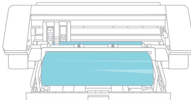
Wenn Sie mit der Rollenzuführung fertig sind, entfernen Sie die Materialrolle, falten Sie die Teile wieder nach unten und schieben Sie das Fach wieder in Position.
