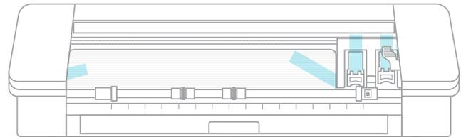
Vergessen Sie nicht, den Klebestreifen auf der Rückseite des Geräts, der den Querschneider an seinem Platz hält, zu entfernen.
