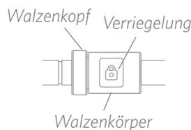
Greifen Sie den Rollenkörper und drücken Sie die Verriegelungstaste.
