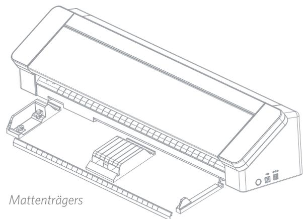
Wenn Sie den Rollenvorschub zusammengebaut haben, stellen Sie das Mittelstück so ein, dass es die Größe des aufgerollten Materials aufnehmen kann. Die Enden des Materials sollten auf den Enden dieser beiden Teile aufliegen. Schieben Sie das mittlere Rollenzuführungsstück so, dass es der Breite Ihres Materials entspricht.
