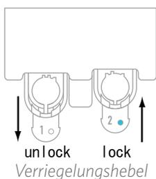
Entsperren Sie zunächst die Position „Werkzeug 1“, indem Sie den Verriegelungshebel herausziehen. Setzen Sie das AutoBlade (oder das Werkzeug oder den Werkzeugadapter, das bzw. den Sie verwenden) in den Werkzeughalter 1 ein und schieben Sie den Verriegelungsmechanismus wieder in Position. Sie können es hilfreich finden, das Werkzeug nach unten zu drücken, während Sie den Verriegelungshebel wieder eindrücken. Dadurch wird sichergestellt, dass das Werkzeug sicher fixiert ist.
