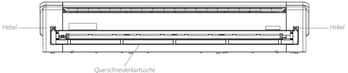
Um die Querschneiderpatrone wieder in das Gerät einzusetzen, richten Sie die Füße an der Unterseite der Querschneiderpatrone so aus, dass sich die Rillen an der Unterseite der Querschneiderpatrone am Silhouette Cameo öffnen. Sobald Sie sicher sind, dass die Ausrichtung korrekt ist, heben Sie die Oberseite der Querschneiderpatrone an und schieben Sie diese in die Öffnung, bis sie hörbar einrastet.
