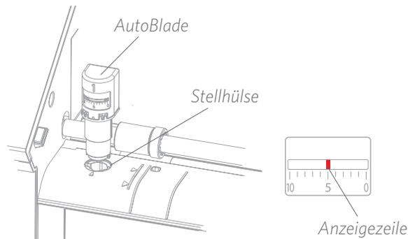
Wenn Sie das AutoBlade verwenden, passt sich das Messer automatisch an, wenn Sie Ihr Design zum Schneiden senden. Um das AutoBlade oder ein anderes Messer manuell einzustellen, verwenden Sie die Stellhülse im Gerät oder das im Lieferumfang enthaltene Handgerät. Drücken Sie das AutoBlade vorsichtig nach oben und nach unten in die Anpassbuchse, bis die rote Anzeigelinie auf die gewünschte Einstellung zeigt.
