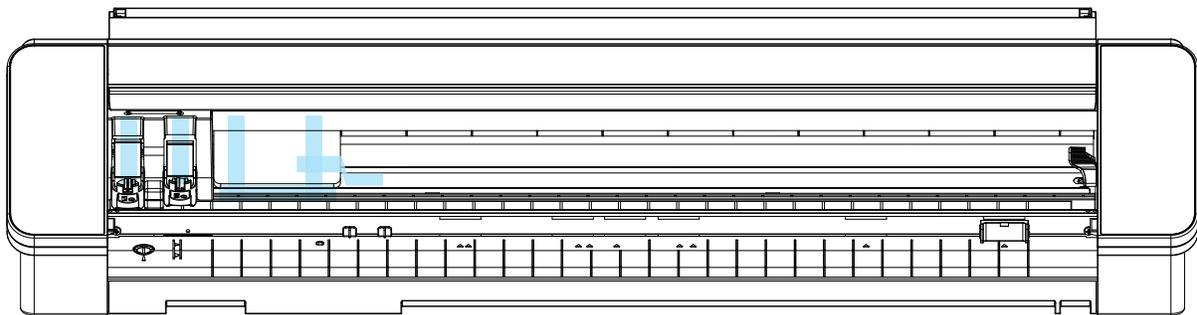
Vergessen Sie nicht, den Klebestreifen auf der Rückseite des Geräts, der den Querschneider an seinem Platz hält, zu entfernen.
