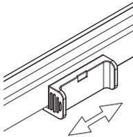
Drücken Sie mit zwei Fingern auf die Kanten des Rollenkörpers oder den größten Einstellhebel auf der rechten Seite der Rollenleiste. Bewegen Sie den Rollenkörper nach rechts oder links in die gewünschte Position.
