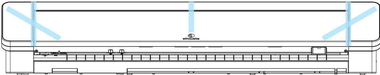
Entfernen Sie die drei Laschen, die die durchsichtigen Kunststoffabdeckungen an der Vorderseite des Geräts festhalten. Entfernen Sie dabei die beiden Teile an den Seitenwänden und das Teil an der Oberseite des Geräts.
