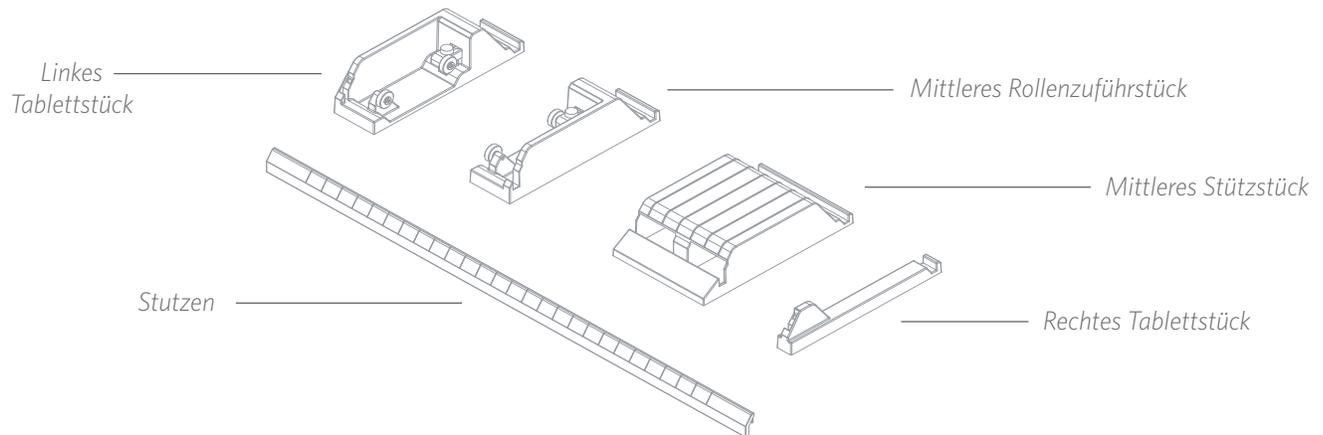
Um die Optionen für den Rollenvorschub oder den Mattenträger zu montieren, richten Sie die beiden Endablageteile, die Sie verwenden möchten, zusätzlich zu dem mittleren Rollenzuführungsstück ODER dem Trägerteil aus. Befestigen Sie diese Teile unter dem Silhouette Cameo Pro Gerät. Verwenden Sie das lange Teil, um die beiden Endstücke des Tablett zu verbinden.
