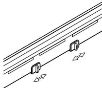
In der Mitte der Rollenleiste befinden sich zwei weitere Mechanismen, die bewegt werden können, um das Material besser zu greifen.
