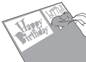
Wenn Sie eine Entgitterlinie schneiden, werden die nicht benötigten Teile in kleinere Teile unterteilt. So wird das Entgittern einfacher.
