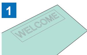
Schneiden Sie das gewünschte Muster mit der Halbschnittfunktion der Schneidmaschine.
