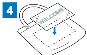
Legen Sie die in Schritt 3 geschnittene Folie mit dem Trägermaterial nach oben auf die Zielfläche, wie zum Beispiel Stoff (\*<sup>1</sup>).
