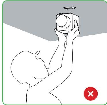
■ Montieren Sie das Wandbefestigungselement niemals seitlich oder an der Decke. Andernfalls könnte das Inline-Gebläse möglicherweise nicht ordnungsgemäß befestigt sein.
