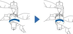
Drehen Sie die Kappe nach rechts. um die Messerspitze bis zur maximalen Länge auszufahren.
