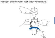
Drehen Sie die Halterkappe zum Entfernen ab.
