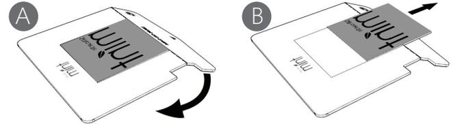
Wenn Sie das Stempelmaterial aus dem Träger entnehmen, kann es sein, dass die transparente Schutzfolie des Trägers auf dem Stempelmaterial klebt. In diesem Fall ziehen Sie zunächst vorsichtig die transparente Schutzfolie vom Träger ab, um dann das Stempelmaterial unbeschädigt entnehmen zu können.
