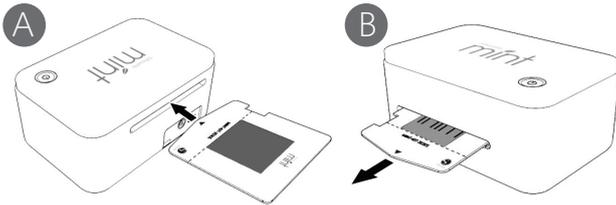
Hinweis: Sollte der Träger mit dem Stempelmaterial im Gerät verhaken oder nicht korrekt ausgeworfen werden, so schieben Sie den Entriegelungshebel auf der Unterseite der Mint auf „RELEASE“ und ziehen den Träger aus dem Gerät. Anschließend schieben Sie den Hebel auf „PRINT“ zurück und starten Ihren Druckauftrag erneut. Sollten wieder Probleme auftreten, so verwenden Sie einen neuen Träger mit Stempelmaterial.
