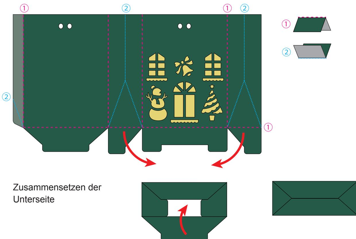
(4) Falten Sie B-1 entlang der gepunkteten Linie, legen Sie es auf das in Schritt (3) zusammengesetzte Teil und führen Sie anschließend das Band durch die Löcher und binden Sie es fest.
